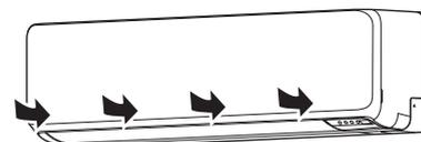
**REMARQUES :** Si de la saleté s'accumule sur le filtre à air, cela réduit le flux d'air, l'efficacité de fonctionnement diminue et le bruit augmente.
